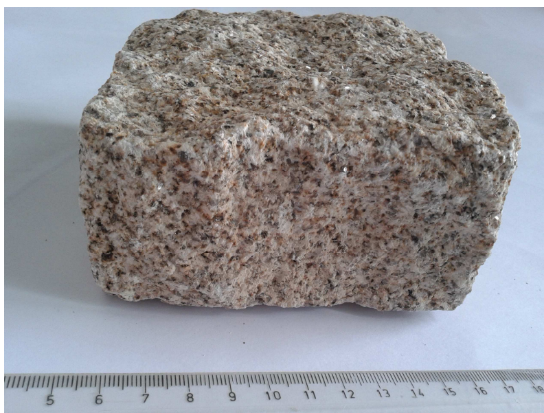
Figura 5.3.6- Amostra de granito explorado na pedreira “Gralha”
